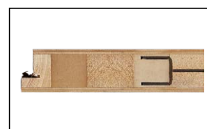
vantail HERSE SET ACOUSTIQUE 39 dB ép. 46 mm, renforcé par un profilé et tôle en acier
