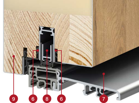
пресек на панелот THERMO HOT 88 со и без дихтунг што се спушта, алуминиумски праг
