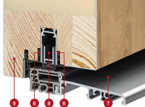
section du vantail THERMO HOT 88 avec et sans joint de bas de porte, seuil en aluminium
