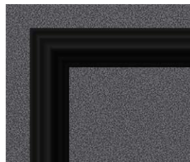
Beidseitig profilierte Leiste, 51 mm breit und 19 mm hoch.
