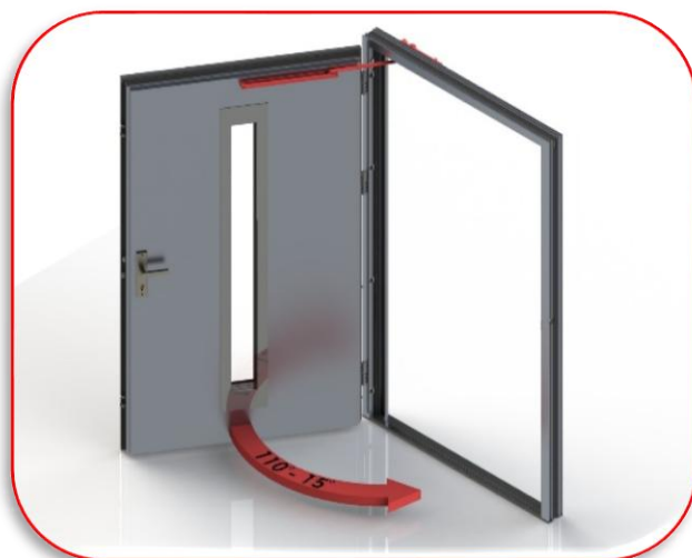
15. La vis marquée « 1 » vous permet de régler la vitesse de fermeture de 110° à 15° pour la méthode d'installation B.
