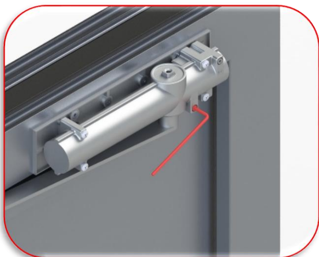
14. Réglez la vitesse de fermeture à l'aide de la vis marquée « 1 » à l'aide d'une clé Allen.
