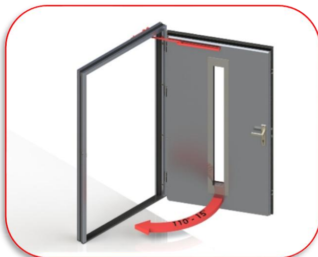
15. Az "1" jelzésű csavar lehetővé teszi a zárási sebesség 110° és 15° közötti beállítását a B szerelési módhoz.
