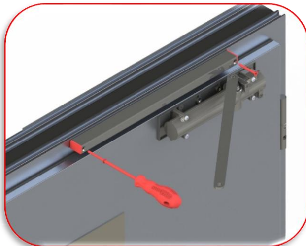
11. Naskrutkujte uzatváraciu koľajnicu.
