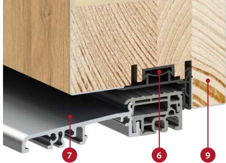
поперечний переріз стулки THERMO HOT 88 з ущільнювачем і без спадаючого ущільнювача, алюмінієвий поріг
