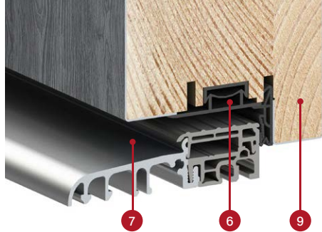
section du vantaill THERMO HOT 78 avec et sans joint de bas de porte, seuil en aluminium
