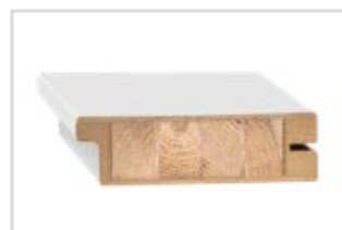
Svislý rám z vrstveně lepeného dřeva obložený deskami HDF a MDF, dostupný za příplatek za dekorální fólie BÍLÁ PREMIUM, DUB NATUR PREMIUM, JASAN GRAFIT PREMIUM, JAVOR ŠEDÝ PREMIUM, DUB ST CPL
