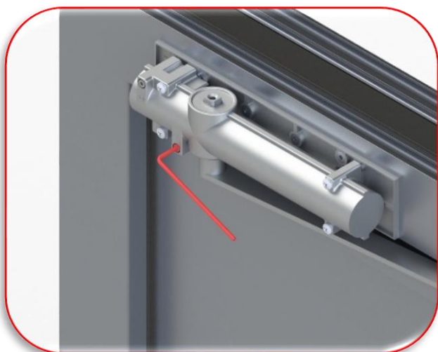
14. Ustawić prędkość domykania za pomocą śruby oznaczonej „1”, używając klucza imbusowego.
